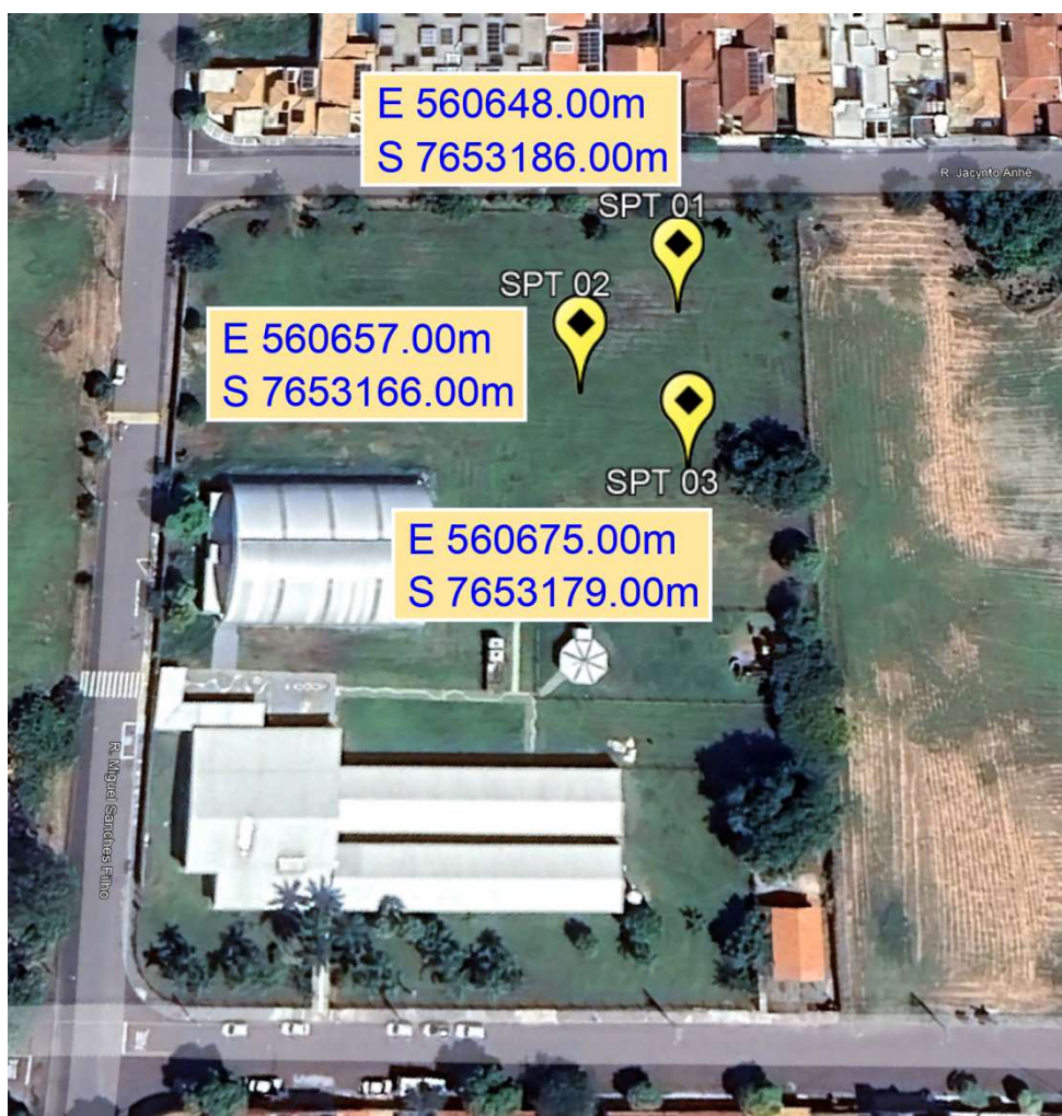
Imagem 1: Localização dos furos SPT
